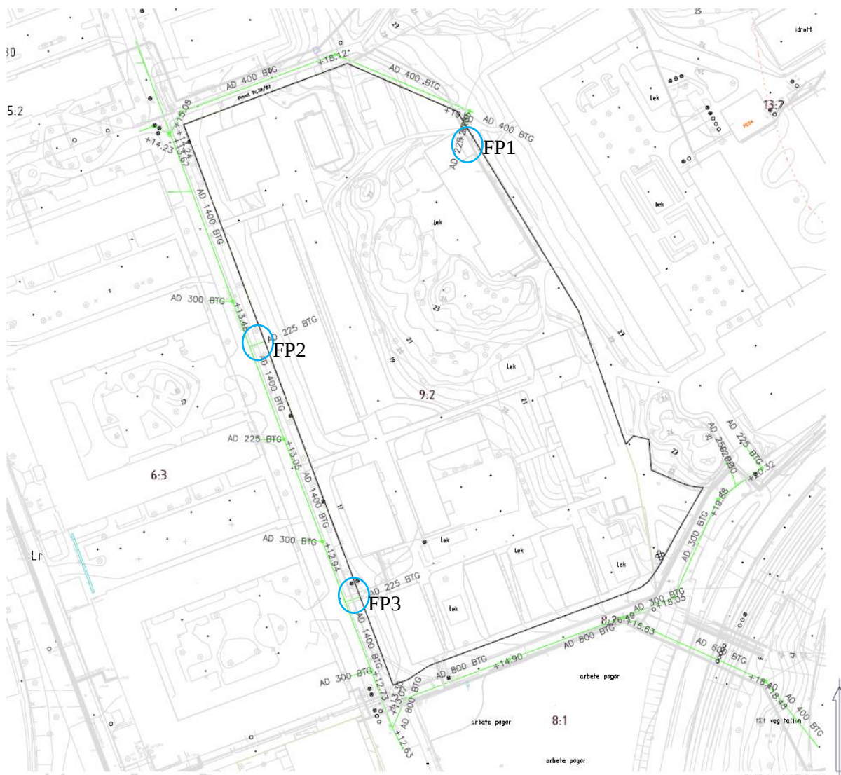
Figur 9. Befintliga dagvattenledningar kring planområdet. Befintliga förbindelsepunkter är markerad med blåa ringar. Plangräns är markerad med svart färg.
